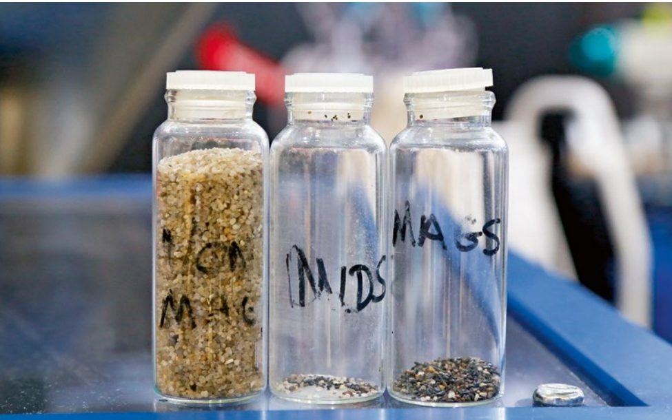
Bild 2 Nichtmagnetische, halb magnetische und magnetische Fragmente nach der magnetischen Abtrennung (© Paul Fears Photography)
